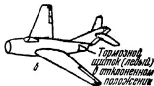
Рис. 194. Время пикирования реактивного самолета с высоты 13 000 м до 11 000 м с применением тормозных щитков и без них, расположение тормозных щитков на фюзеляже
