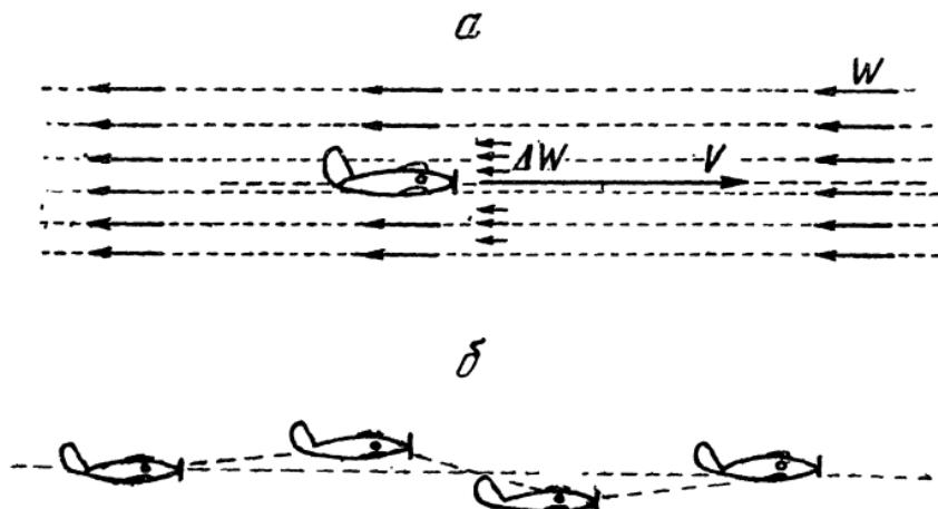
Рис. 69. Влияние порывистого ветра на горизонтальный полет самолета
