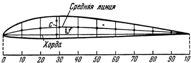
Рис. 14. Максимальная кривизна и максимальная толщина профиля крыла
