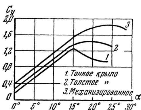
Рис. 157. Изменение коэффициента подъемной силы с увеличением угла атаки у тонкого, толстого и механизированного крыльев
