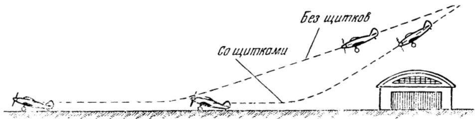
Рис. 133. Угол планирования при подходе к земле с выпущенными щитками и без щитков
