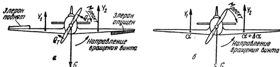
Рис. 101. Реактивный момент винта и уравновешивание его:
