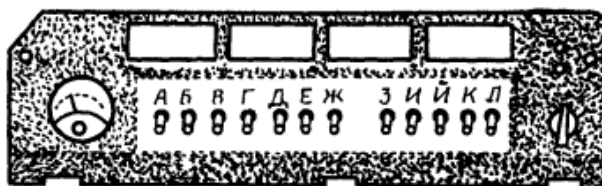
Рис. 13. Электрощиток (для самолетов выпуска до 1981 г.)
